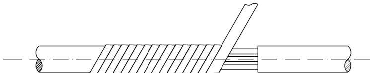
Рис. 10. Обмотка электрокабеля полуступами
