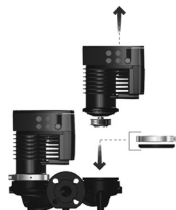
Рис. 37 Установка глухого фланца
