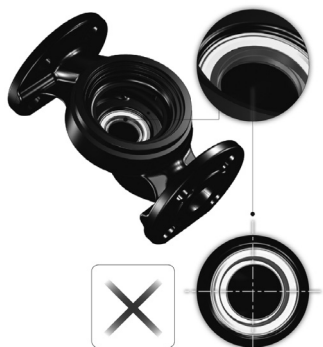
Рис. 17 Неправильно выровненная система уплотнений
