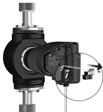
35-сур. Релелік шығыстың қорғаныс қақпағын бөлшектеу.
