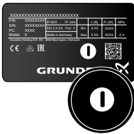
Նկար 34 Գլխավոր գլխամասի նշագիրը ֆիրմային վահանակի վրա (գործարանային տեղադրում)
