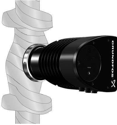
Նկար 19 Պոմպի հենամարմնի և խողովակաշարի մեկուսապատվածք
