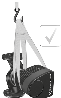
Рис. 9 Правильный способ стропки насоса
