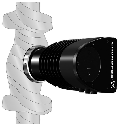
Рис. 19 Изоляция корпуса насоса и трубопровода
